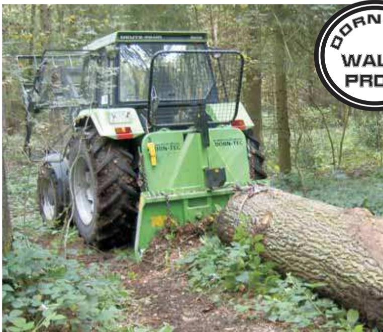
Treuil electrohydraulique 6500 EH avec radiocommande
